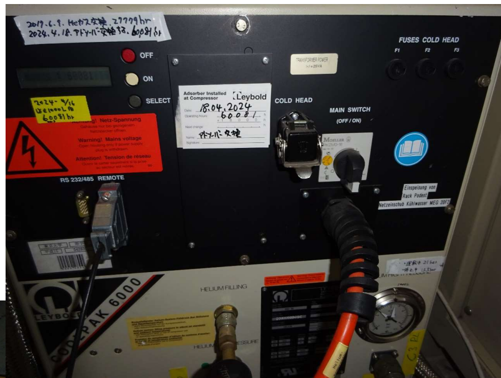
LXe1000L dewer用冷凍機 圧縮機 運転時間2024/04/18 60,081時間
