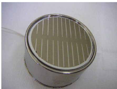
図 3.3: MEG II 実験 LXe 検出器 PMT [7]。光電面表面にアルミニウムストリップが貼り付けてある。
