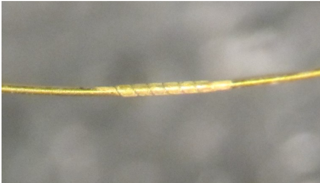
図 3.10: LXe 検出器に設置されている ^{241}\text{Am} 。 ^{241}\text{Am} は金メッキタングステンワイヤーに巻かれ、金で覆われている [1]。
