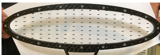
図 2.4: MEG II 実験ミュオン停止ターゲット [2]
