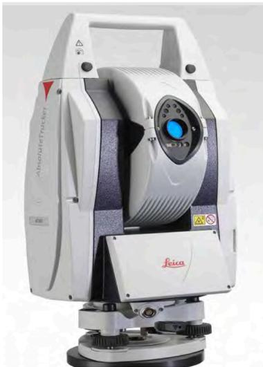
図 5.3: レーザートラッカー (Leica Absolute Tracker AT960)
