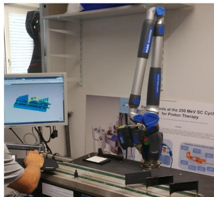
図 5.8: 使用した 3D スキャナー (FARO Edge ScanArm HD)
