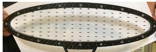
図 3.17 MEG II 実験の  $\mu$  ビーム静止ターゲット [10]。モニター用のパターンが印刷されている。
