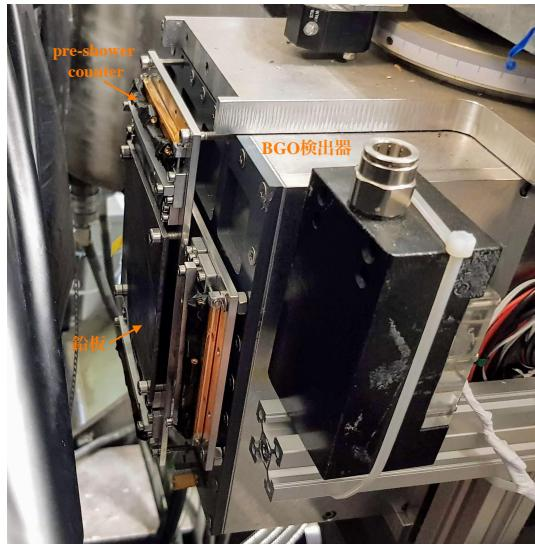
図 7.29 BGO 検出器の直前に設置された pre-shower counter。2枚のプラスチックシンチレータを交互に重ね、前面には鉛板を設置している。
