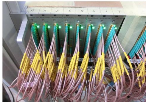
図 2.28 (左)WaveDREAM ボードプロトタイプ、(右)クレートプロトタイプ (この写真はクレートの左半分を写している)
