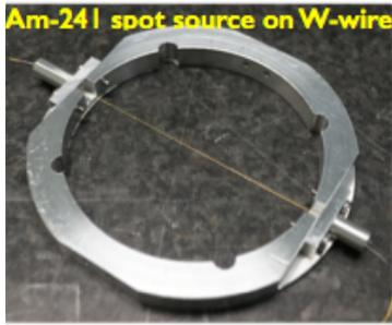
図 4.3 本試験で使用するアルファ線源。タングステンワイヤーの中央に存在する。(非常に小さいためこの写真では直接見えない)
