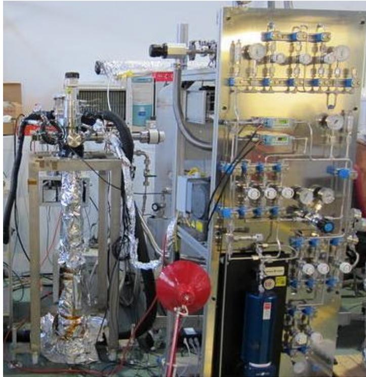
図 4.1 試験装置。写真右側にゲッターを含めたキセノン操作パネルが、左側に真空容器および冷凍機が見える。
