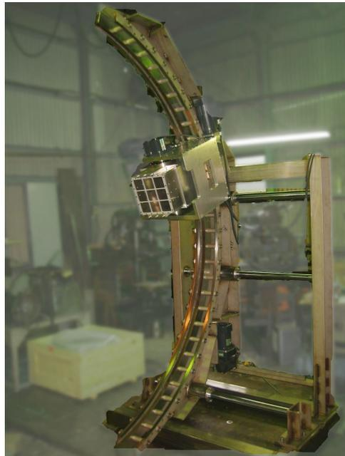
図 2.15  $\pi^0$  中間子から back-to-back に出たガンマ線をとらえるための BGO 検出器。検出器全体をスキャンするために位置を動かせるようになっている。
