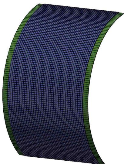
図 3.13 実機の入射面への MPPC の設置 (概念図)
