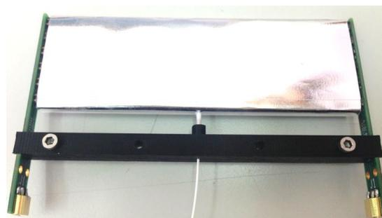
図 2.22 小型カウンター。シンチレータの側面に貼り付けられた SiPM で両側から信号を読み出す。
