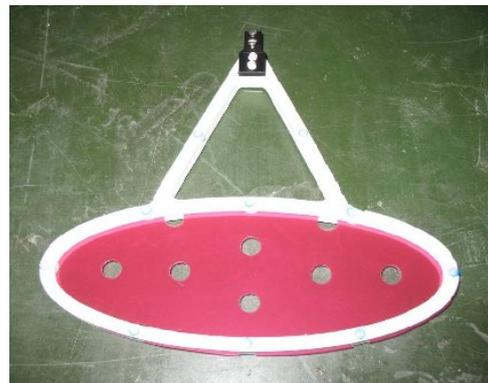
図 2.6 MEG 実験で使用されたビーム静止標的。幾つか空いている穴は、位置の較正に用いる。
