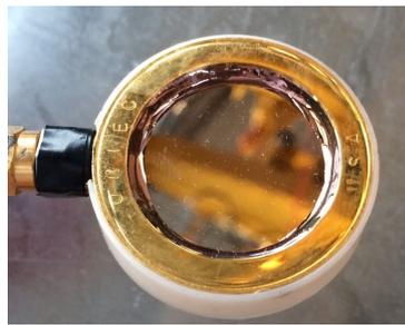
図 4.4 エネルギー分布の測定に使用した SSB 検出器
