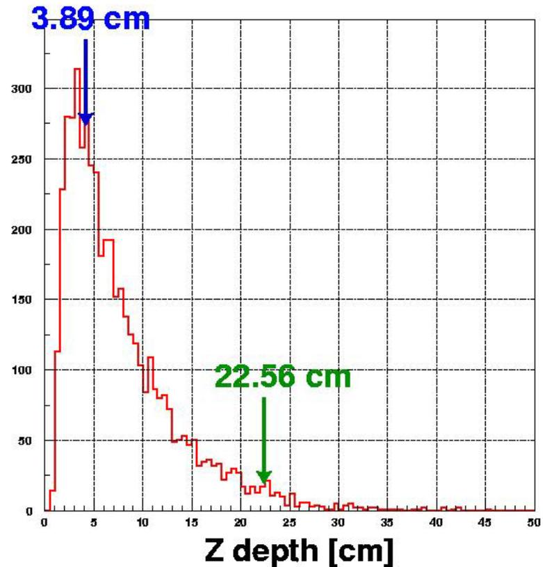
**Position resolution:**  $\delta x, \delta y \sim 4\text{mm}$ ,  $\delta z \sim 16\text{mm}$  FWHM
