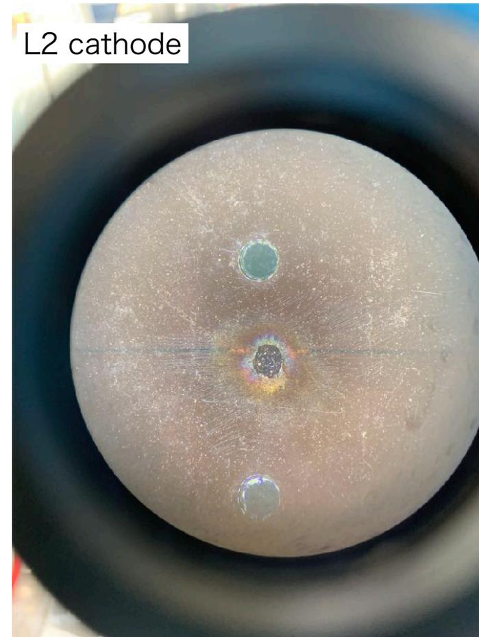
カプトンを突き抜けて導通している
