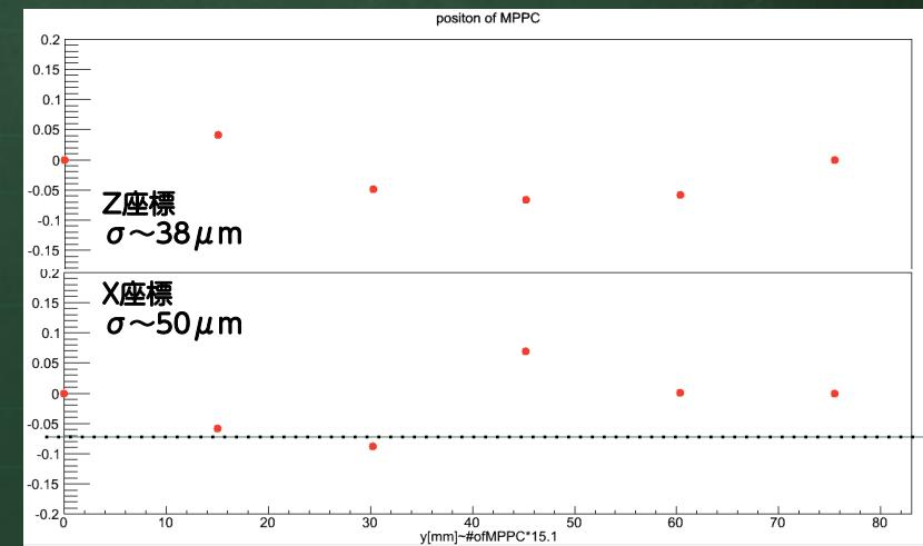
隣り合うMPPC間の距離から要求精度である数 $100\mu\text{m}$ を達成。
