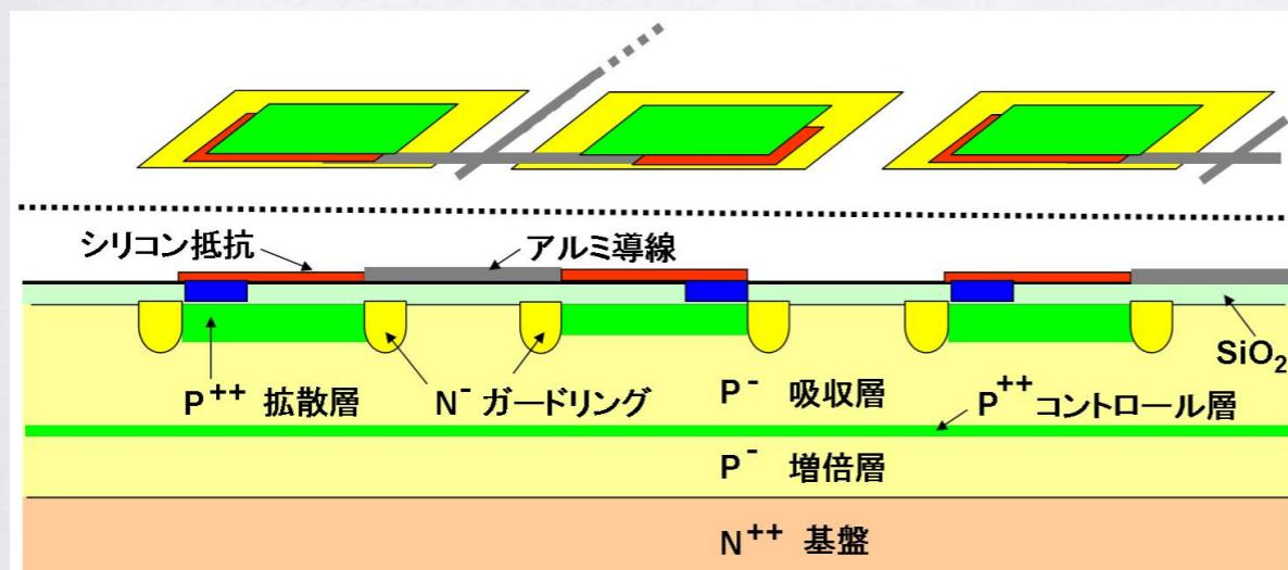
図 2.7: MPPC の断面図
